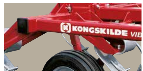
VF 2000/4200/4300 och 4000, Kraftig ramkonstruktion med fyrkantrör.
